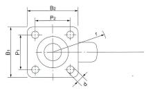
■材質/Material 本体:SPCC ホイール:特殊合成樹脂 主軸、車軸:SWCH
