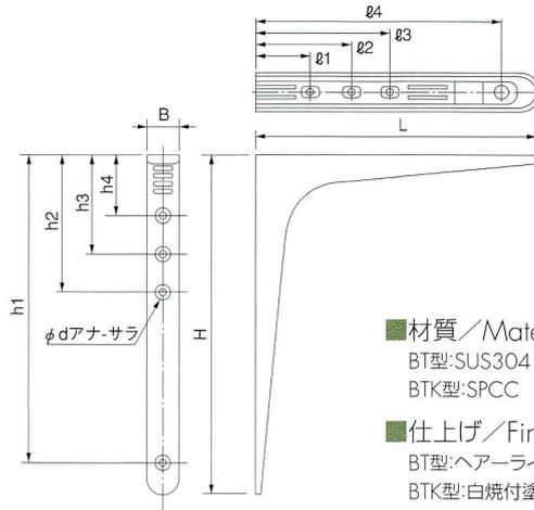
プレス成形の芸術品、深絞り成形で十分な強度があります。さらに裏側を補強板で強化してあるので安全。うしろのコーナーもすき間なくピッタリ取り付けられるよう、気を配って設計しています。BT型は、スリムで耐久性抜群のステンレス製ブラケット。BTK型は、黒、アンバー、又は白焼付塗装の鋼製ブラケットです。
