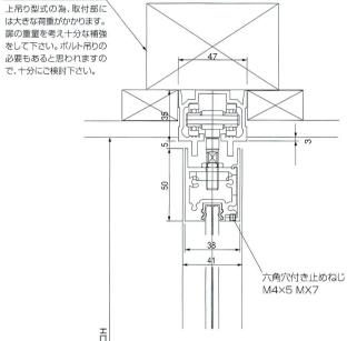
■扉サイズ 扉1枚の最大寸法:W1200×H2400 ■調整幅(上レールと扉の隙間) 5+5mm -3mm
